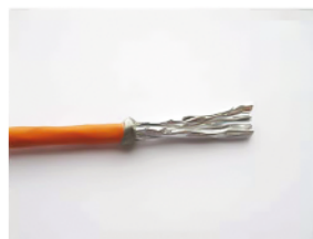
Vorbereiten der Kabelabschirmung Prepare the shielding
