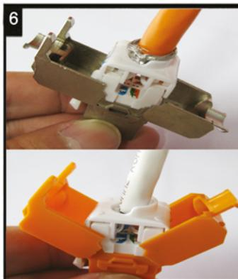
Den Sortierer in Pfeilrichtung in das Modul einsetzen. Bitte Pfeilrichtung beachten!
