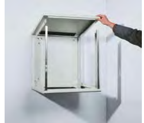
Deckel wie Boden montieren und mit den Vertikalstreben verschrauben. Eckverbinder einbauen und verschrauben
