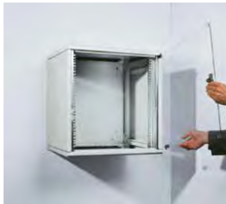
482,6 mm (19")-Lochwinkel in der gewünschten Position montieren und Seitenwände links und rechts einschieben. Anschließend Glastür einhängen, indem man zuerst den oberen Scharnierbolzen in die obere Bohrung einschiebt und dann wieder nach unten in die untere Bohrung gleiten lässt. Anschließend die Tür oben mit rotem Sicherungsring sichern
