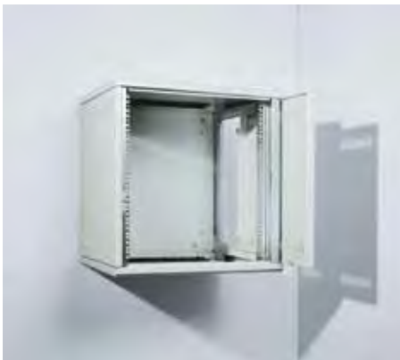
482,6 mm (19")-Lochwinkel in der gewünschten Position montieren und Seitenwände links und rechts einschieben. Anschließend Glastür einhängen, indem man zuerst den oberen Scharnierbolzen in die obere Bohrung einschiebt und dann wieder nach unten in die untere Bohrung gleiten lässt. Anschließend die Tür oben mit rotem Sicherungsring sichern
